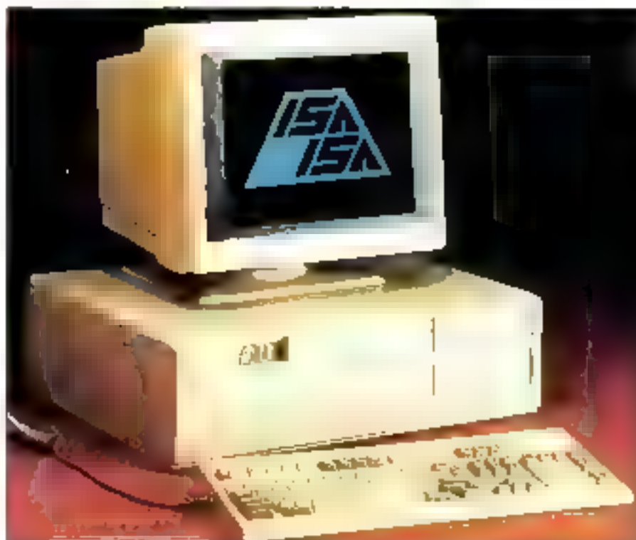
Le Z-386/33E de Zenith. En dehors de son contrôleur de disque et de ses connecteurs EISA, il est pratiquement identique au précédent système 386 à 33 MHz de Zenith.
